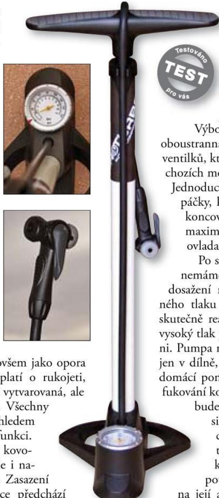
přesně od toho je na manometru otočný prstenec s červenou šípkou, s jejíž pomocí si nastavíme požadovaný tlak a pak už stačí jen hlídat rafičku.
